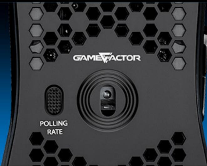
**Sensor de alta precisión.** Equipado con un sensor Pixart modelo 3327 el MOG501 garantiza precisión extrema, sus 6,200 DPI nativos y hasta 12,400 DPI interpolados te dan una ventaja competitiva real en el campo de batalla.
