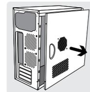
1. Retira la tapa del gabinete, el método para retirar la cubierta puede variar dependiendo del modelo. Consulta el manual del equipo para esta operación.
