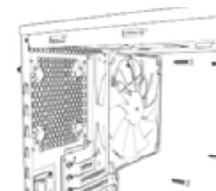
3. Coloque el ventilador en cualquier parte de su gabinete que acepte ventiladores de 120 mm y fije los ventiladores con los tornillos incluidos en la caja
