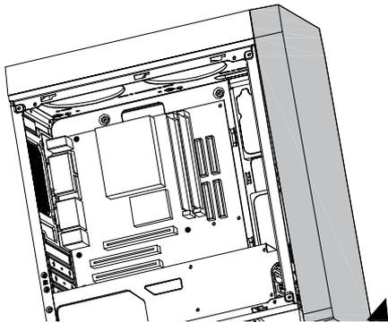
c) Fija los ventiladores superiores con los tornillos correspondientes.
