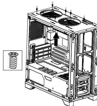
d) Fija los ventiladores o panel de enfriamiento por agua en el panel frontal.
