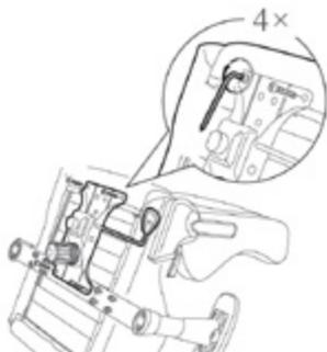
6. Inserte el sistema hidráulico al sistema de control para finalizar la instalación.
