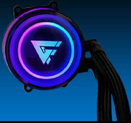
**ARGB.** Conéctalo a tu motherboard y sincroniza su iluminación con el resto de tu equipo. Es compatible con la mayoría de motherboards con conector A-RGB de 3 pines. ¿No tienes motherboard RGB? No pasa nada, tu LQG501 mostrará diferentes efectos de iluminación automáticamente.
